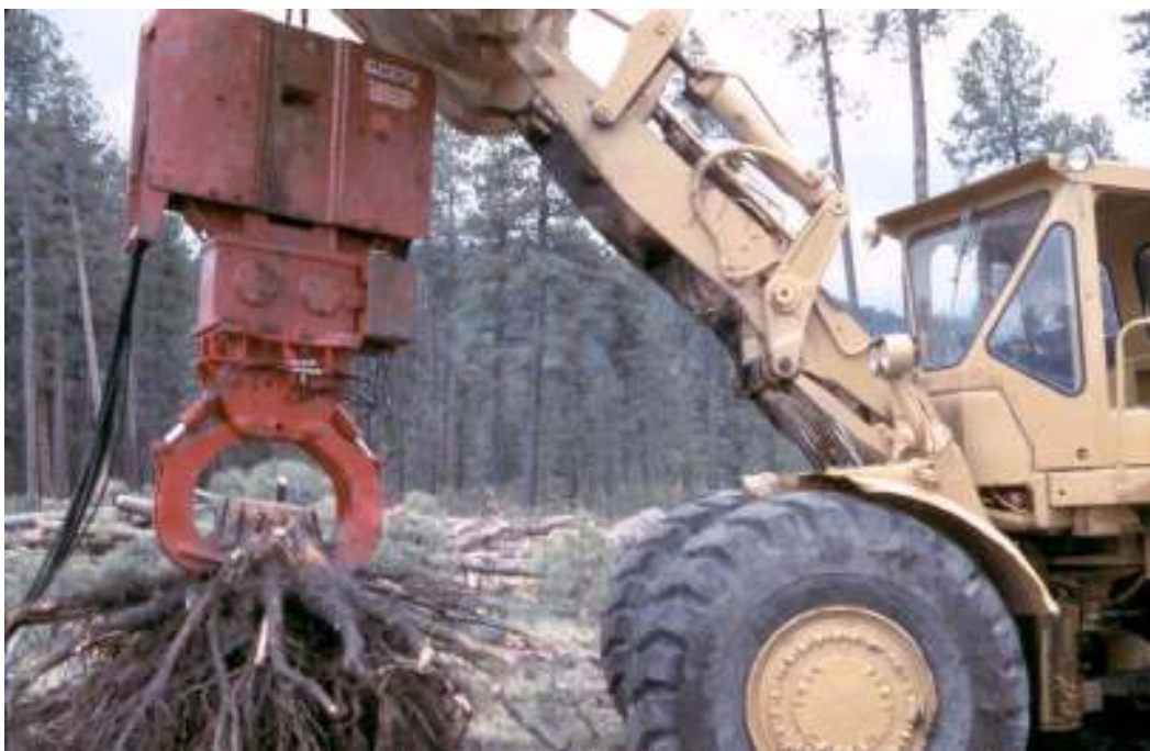
Sl.11: Uređaj za vađenje panjeva
