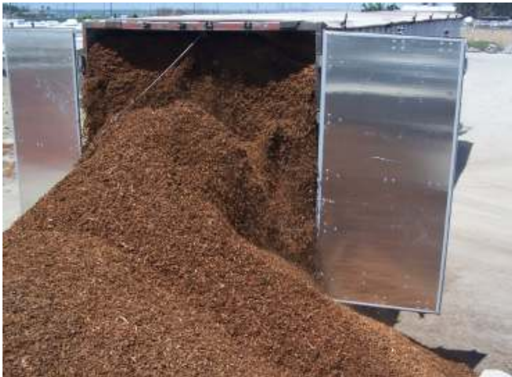
Sl.15: Prikolica sa pokretnim podom
