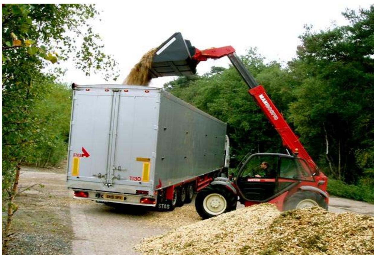
Sl.16: Telehandler tovari drvenu sečku u prikolicu sa pokretnim podom
