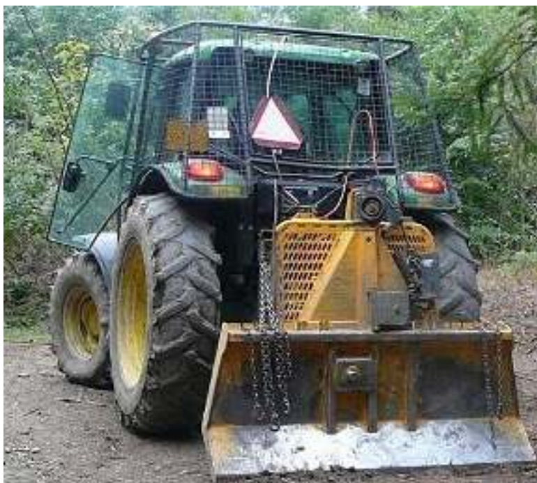
Sl.7: Poljoprivredni traktor adaptiran za rad u šumi
